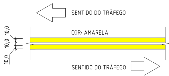
Linha de Divisão de Fluxos Opostos (LFO) Linha Dupla Contínua (LFO-3) e=10cm Cor amarela
